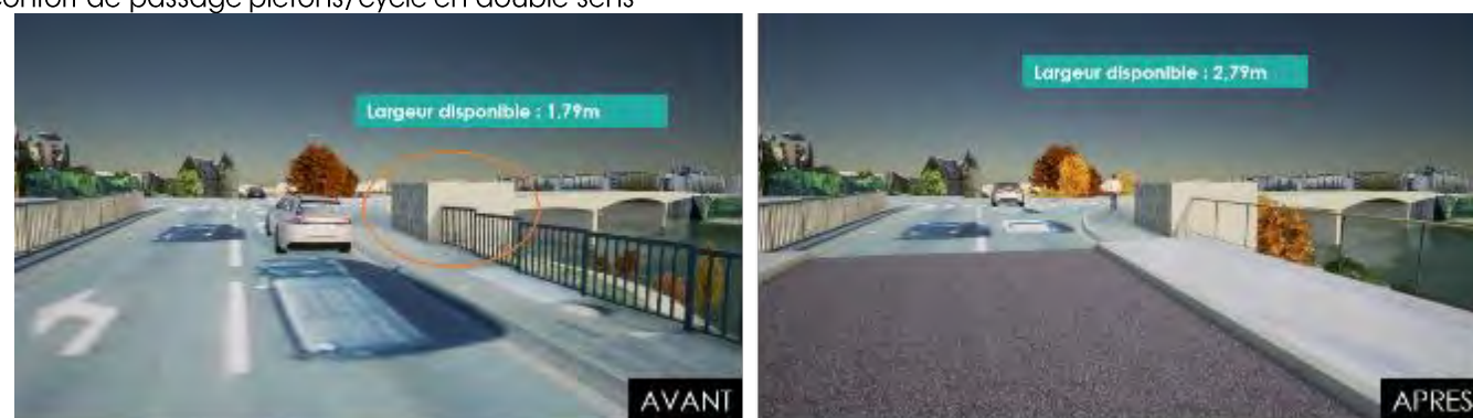
Figure 82 : Largeur de passage avant/après au niveau du Monument aux Morts
