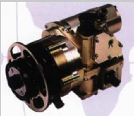
Artus. Actionneur électro-mécanique pour l'indexage et le repliage des pales de l'hélicoptère NH 90 d'Eurocopter. Cliché Artus.
