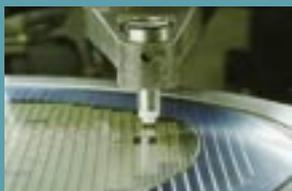
Machine de prise et dépose de puces électroniques. 2006. Cliché Continental.
